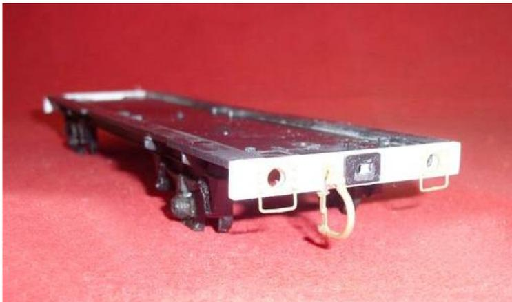
An die Unterseite werden Bremsdreiecken in 1 mm Draht geklebt, zwischen die Bremsklötze.
